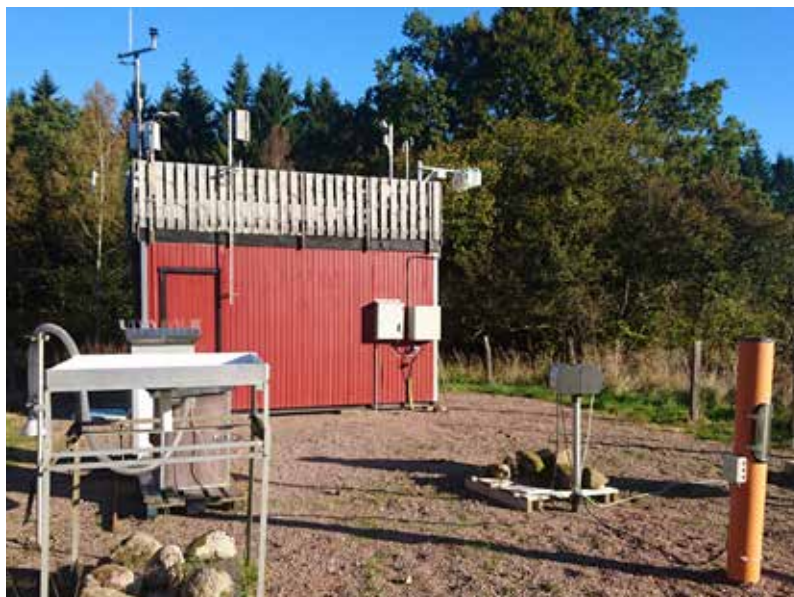
Nationell mätstation i regional bakgrund vid Hallahus, Skåne. Här mäts svavel- och kväveföreningar, basketjoner, marknära ozon, metaller, organiska miljögifter och pesticider.
