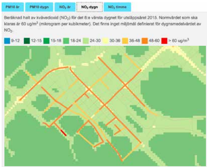
FIGUR 1. Modellberäkningar, här över Uppsala, är ett värdefullt komplement till mätningar genom att man kan beräkna halterna av luftföroreningar även på de platser där mätningar inte finns.
