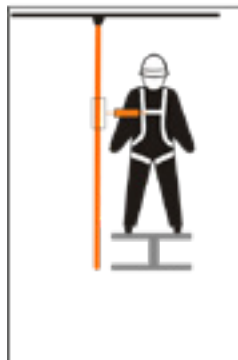
Styrt glidlås med flexibel förankringslina
