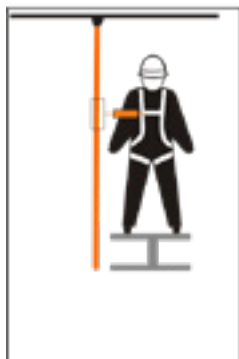
Dispozitiv de asigurare cu rulare sincronă, cu ghidaj mobil
