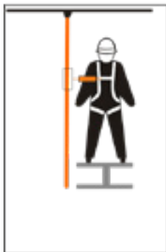
Taipuisassa johteessa liikkuva liukutarrain
