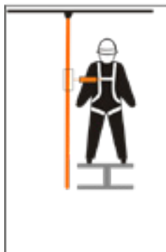
Antiques das do tipo guiado, incluindo um cabo flexível de ancoragem
