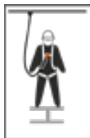
Χαλύβδινος κρίκος πρόσδεσης στην πλάτη με χαρακτηρισμό «A»
