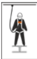
2 faldsikringsstroppe i brystrømrådet, betegnet med "½ A"
