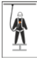
Stahl-Rücken-Auffangöse mit "A" bezeichnet
