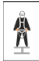
Moleminpuoliset teräksiset kiinnitysrenkaat
