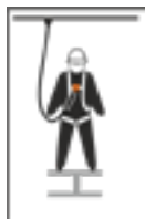
Hátoldali acél felfogószem jelölése „A”
