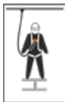
Boucle de retenue dorsale en acier désignée par « A »
