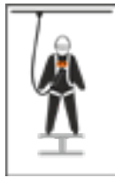
2 Auffangschlaufen im Brustbereich, bezeichnet mit "A"
