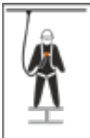
Χαλύβδινος κρίκος πρόσδεσης ανάσχεσης με χαρακτηρισμό «Α»
