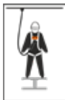
2 pętla zaczepowe na klatce piersiowej, oznaczone symbolem „1/2 A”
