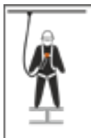
Anilla de enganche en la espalda de acero identificado con "A"
