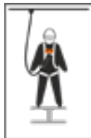
2 θηλιές πρόσδεσης στην περιοχή του στήθους με χαρακτηρισμό «1/2 Α»
