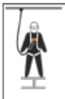
Stahl-Rücken-Auffangöse mit "A" bezeichnet
