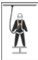
Fangløkke rygg i stål merket med "A"
