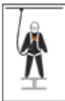
2 pętle zaczepowe na klatce piersiowej, oznaczoną symbolem „1/2 A”
