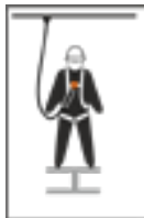
Fångögla av stål på ryggen märkt med A
