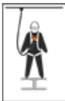
2 θηλιές πρόσδεσης στην περιοχή του στήθους με χαρακτηρισμό «½ A»
