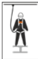
2 Auffangschlaufen im Brustbereich, bezeichnet mit "1/2 A"
