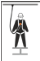
Χαλύβδινος κρίκος πρόσδεσης στην πλάτη με χαρακτηρισμό «Α»
