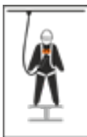
2 räddningsslingor vid brösten, märkta med 1/2 A
