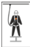
Anilla de enganche en la espalda de acero identificada con "A"
