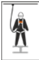
2 räddningsslingor vid brösten, märkta med 1/2 A
