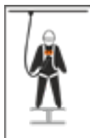
2 opvanglussen rond de borst, aangegeven met "1/2 A"
