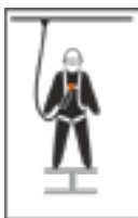
Anilla de enganche en la espalda de acero identificado con "A"
